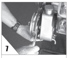
TIGHTEN water pump pivot bolt.
