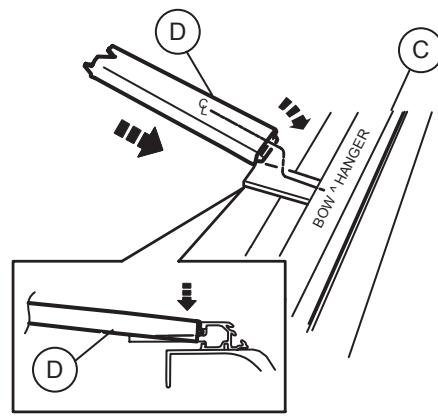
El arco se reclina sobre la tapa de la abrazadera con cada uno de sus piernas cubiertas sobre los lados.
