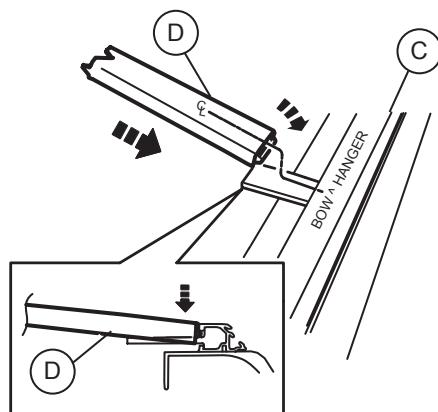
L'arc se repose sur le dessus de la bride avec chacune de ses jambes drapées au-dessus des côtés.
