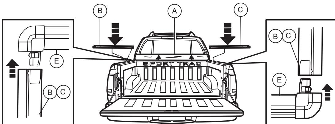
Raccorder les rails côté conducteur et côté passager au rail avant.
