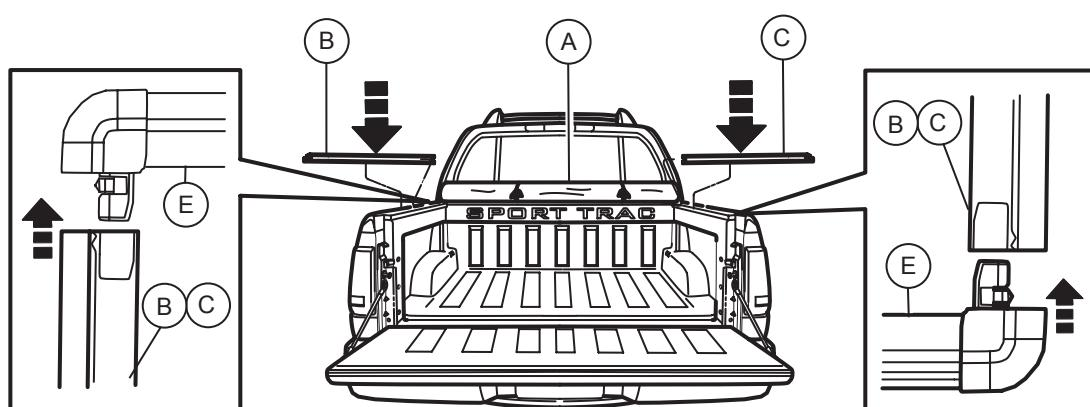
Conecte los rieles del lado del conductor y del lado del pasajero con el riel delantero. La flecha apunta hacia la parte delantera de la camioneta.
