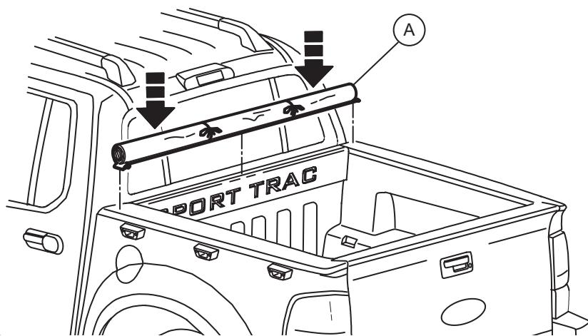
Coloque el ensamble de la cubierta y el riel delantero en la parte superior de la caja junto a la cabina.
