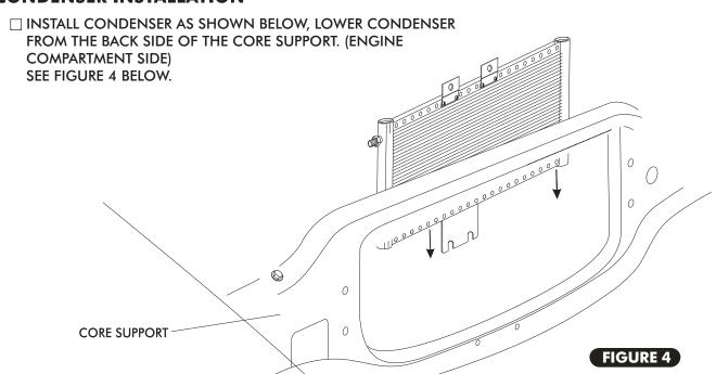
■ NOTE: THE TOP MOUNTING BRACKET GOES ON THE FRONT SIDE OF THE CORE SUPPORT.
