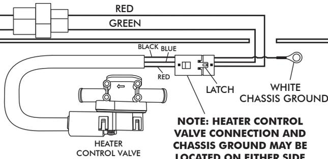
**NOTE: HEATER CONTROL VALVE CONNECTION AND CHASSIS GROUND MAY BE LOCATED ON EITHER SIDE OF THE FIREWALL. ENSURE CONNECTOR IS LATCHED FIRMLY.**
