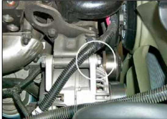
18. Remove the upper alternator bolt.
