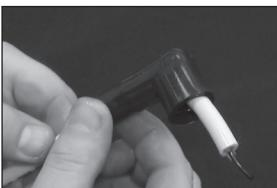
3. Utilice los orificios de 7 mm u 8 mm en la tenaza engarzadora de ACCEL y haga pasar el cable a través del orificio con el extremo parejo.
