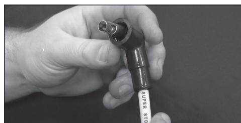
12. Para los capuchones estilo HEI: lubrique levemente el terminal con grasa dieléctrica y haga deslizar el cable dentro del capuchón estilo HEI.
